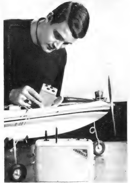
Der Empfänger wird gerade in ein Flugmodell eingebaut. Im Vordergrund der Sender
