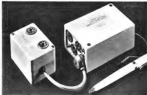
Bild 4. Der vollständige Zehnkanaal-Empfänger bestehend aus den Einheiten 195/2 und 195/4
